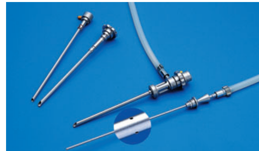
Bild 2 zeigt einen Saug-/Spülschaft, der früher zweiteilig hergestellt wurde (im Bild links oben). Die neue Version besteht aus einem Teil, welches durch die Verwendung von 2 Spüladaptern für die maschinelle Dekontamination konzipiert wurde. Der mit Spülbohrungen versehene Dorn für die Reinigung des zentralen Kanals, der zweite (nur für den Reinigungsschritt anzubringende) Adapter für die Reinigung des geometrisch komplexen Spülkanals zwischen Innen- und Außenrohr.
