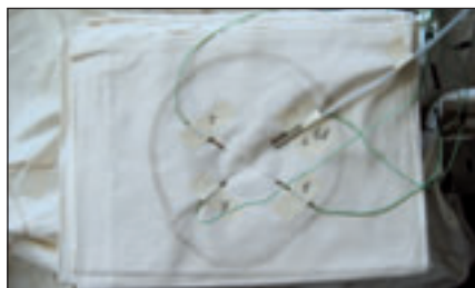
Abb. 3: Platzierung der Pt 1000 und der Thermoelemente Typ K.
