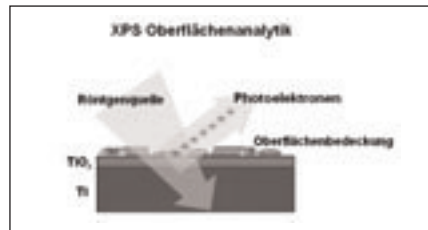
Abb. 3 zeigt den schematischen Aufbau eines XPS (X-ray photoemission spectroscopy) - Spektrometers, mit dem eine atomselektive Analyse einer Oberfläche möglich ist.
