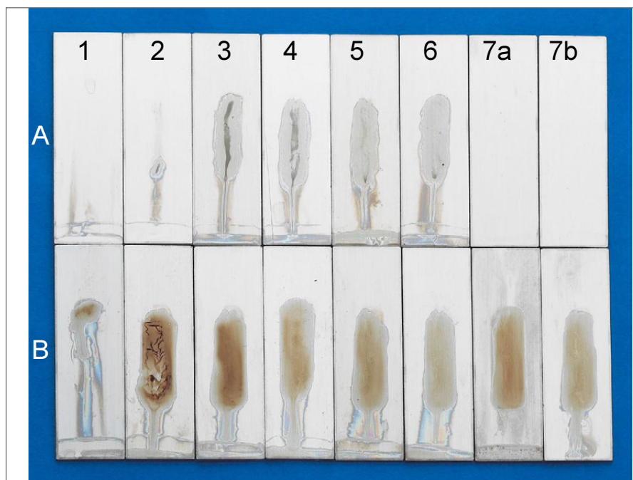
Abb. 5b Fotografien der TOSI Prüfkörper am Ende des Versuchs. Reihe A: Diese Prüfkörper wurden zum Zeitpunkt 0 in ein Becherglas mit VE-Wasser gestellt. Die Dosierung der Reiniger erfolgte jeweils bei Erreichen von 30 °C. Reihe B: Prüfkörper, die am Ende der Inkubation der oberen Prüfkörper bei ausgeschalteter Heizung während 5 Minuten in die heisse Lösung getaucht wurden (vergleichbar mit dem Vorgehen von Michels und Pieper bei ihren Tauchversuchen mit dem blutbelasteten Filterpapier (11)).
