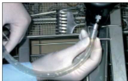
Abbildung 6: Schritt V: den Luerlock mit dem Anschluss verbinden
