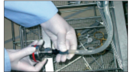
Abbildung 7: Schritt VI: Druck/Temperaturlogger an den Schlauch anschließen (hier verwendeter Logger von Ebro)
