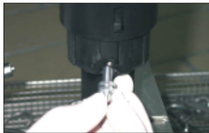
Abbildung 4: III. Schritt: Luerlock einschrauben
