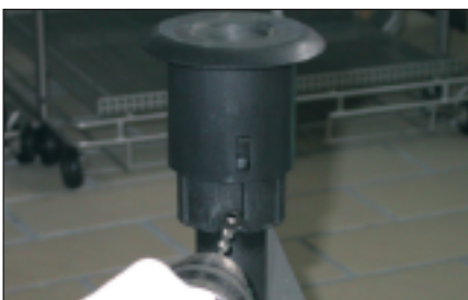
Abbildung 2: I. Schritt: ein 5mm Loch in den Feststerring des Adapters bohren.
