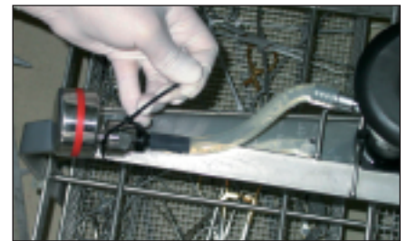
Abbildung 8: Schritt VII: Druck/Temperaturlogger mit einem Kabelbinder fixieren (sowohl der Logger als auch der Kabelbinder dürfen unter keinen Umständen in den Bereich des Spülarms gelangen)
