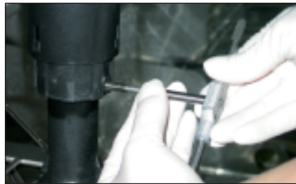
Abbildung 3: II. Schritt: M 6 Gewinde einschneiden
