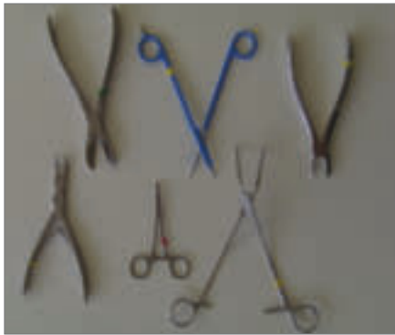
Abb. 1: Gruppe-2-Instrumente: Es wurden verschiedene Gelenkausbildungen und Materialien untersucht. Von links nach rechts: Doppelgelenkinstrument; Seitenschneider (großer Durchsteckschluss), Crile-Klemme (kleiner Durchsteckschluss), Bipolare Schere, DeBakey-Zange (mittlerer Durchsteckschluss), Zahnarztzange (Drehgelenk)
